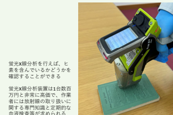
蛍光X線分析装置は1台数百万円と非常に高価で、作業時には放射線の取り扱いに関する専門知識と定期的な血液検査等が求められる
